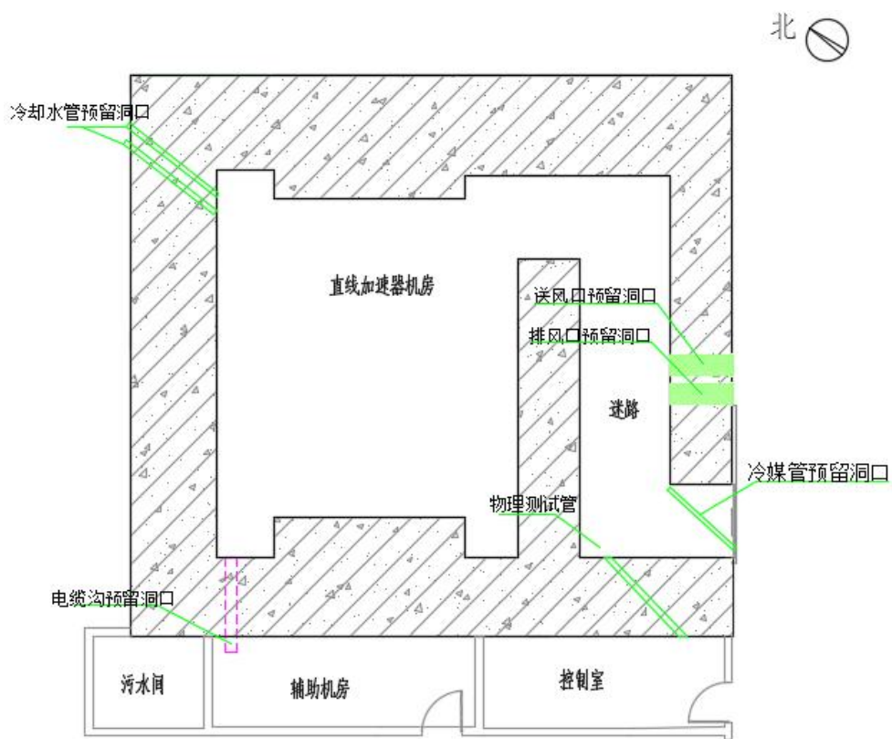
图 10-2 直线加速器机房穿墙管线平面布置示意
