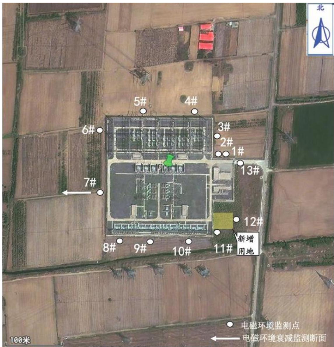
图 6.1-1 乐亨 500kV 变电站电磁监测布点图
