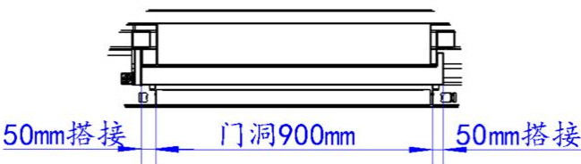
正面进样门搭接
