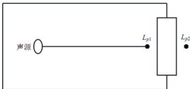
图5.2.3-1 室内声源等效为室外声源图例
