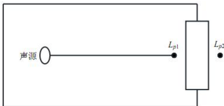
图5.2.3-1 室内声源等效为室外声源图例
