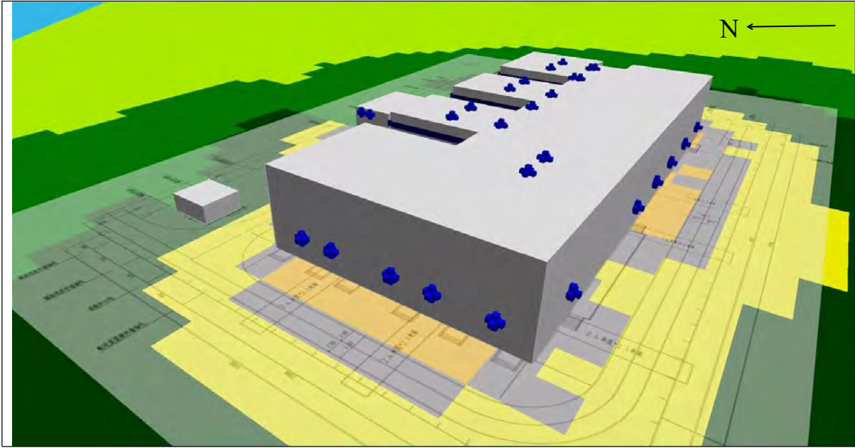
图 4-4 220kV 界石堡变电站噪声预测模型图
