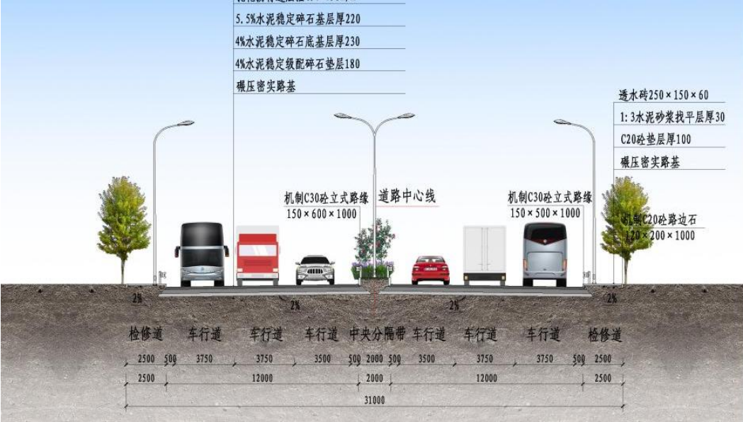
图 2.4-1 路基段双向六车道标准横断面图（单位：mm）
