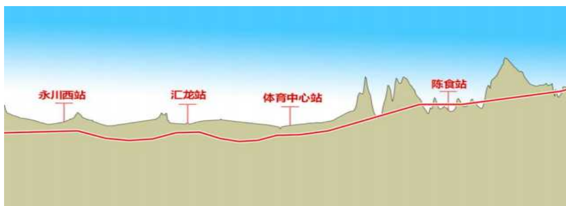
图 2.5.1-4 地下敷设方案纵断面示意图
