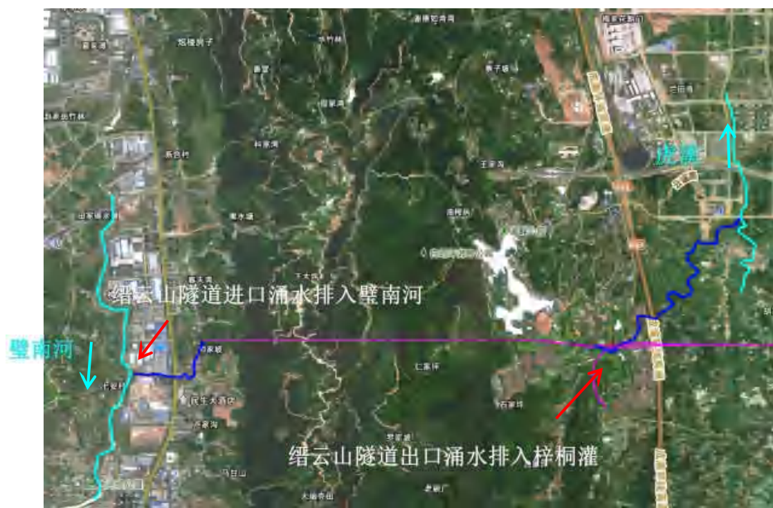
图 4.4.4-2 缙云山隧道涌水排水去向
