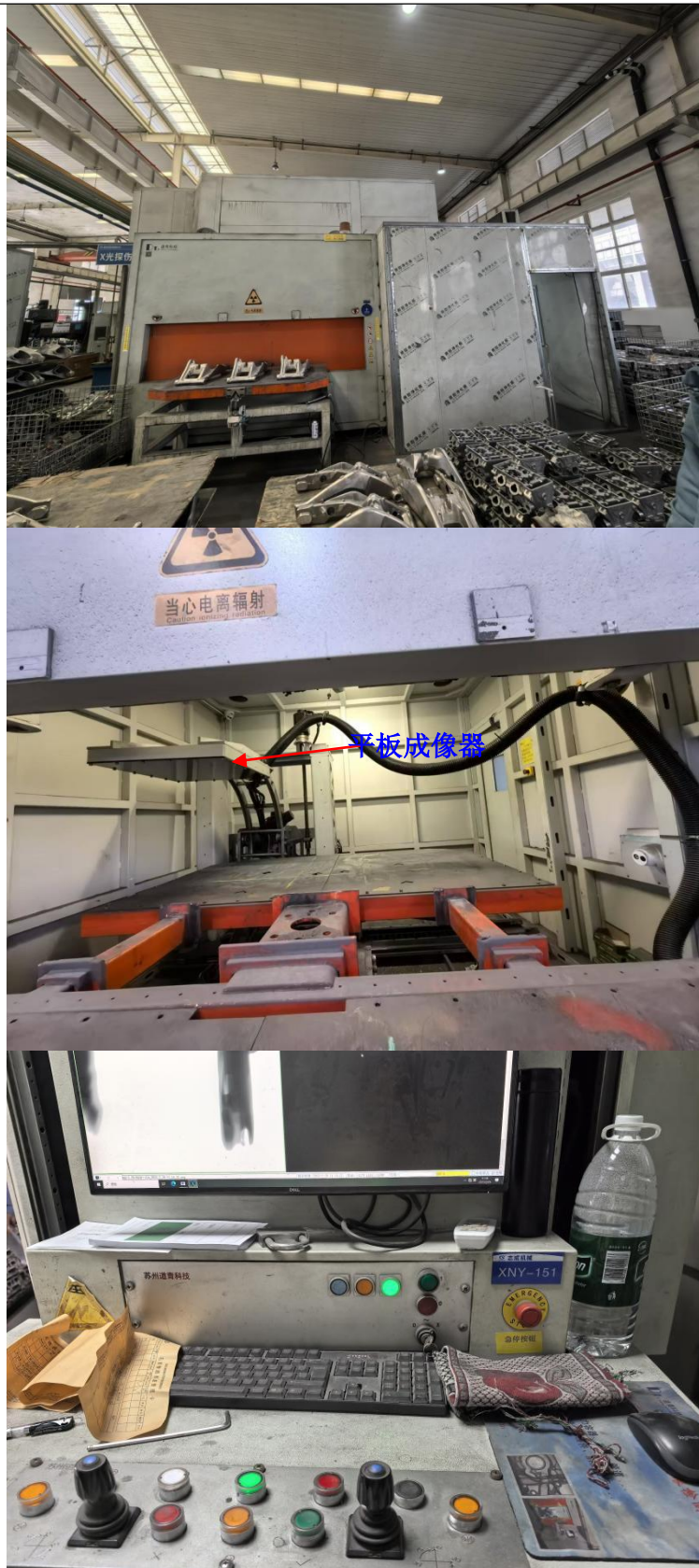
图 9-1 拟搬迁的生产车间二 X 光探伤区苏州道青 DU310 型整体、铅房内部、操作台照片
