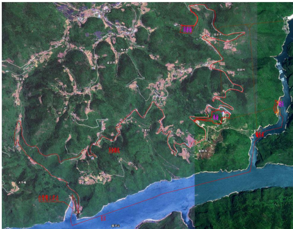
图 2.1-1 港池开挖弃渣转运路线图
