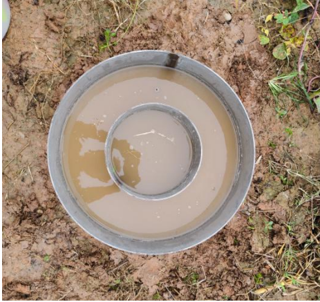
SS01 足 219 井场周边渗水试验现场照片
