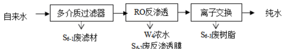
图3.4-1 纯水机工艺流程图
