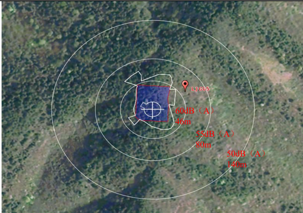
图 4.2-2 平均风速下风机运行噪声预测等声值线图 (内圈 46m, 噪声值 60dB (A); 中圈 80m, 噪声值 55dB (A) 外圈 140m, 噪声值 50dB (A))
