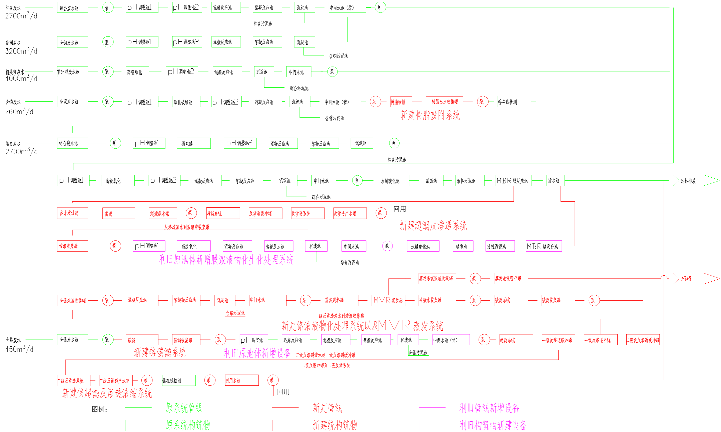
图 3.1-1 加工区污水处理厂提标改造后工艺流程图
