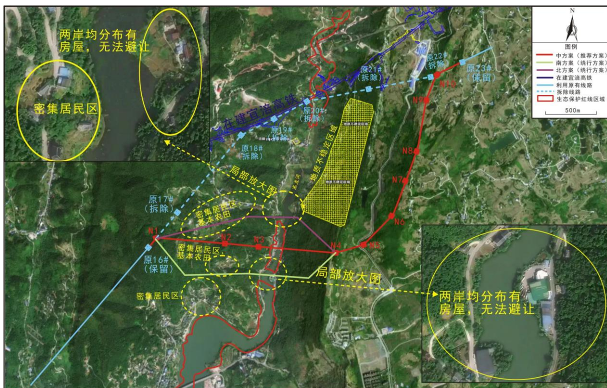
图2-2 本项目迁改线路跨越生态保护红线比选方案图（源于《宜涪高铁电力线路迁改工程（220kV 中清线17#~22#迁改工程）生态保护红线内有限人为活动论证报告》）
