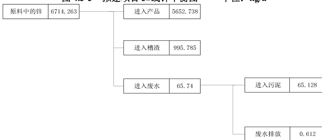
图 4.3-3 拟建项目 3#线锌平衡图
