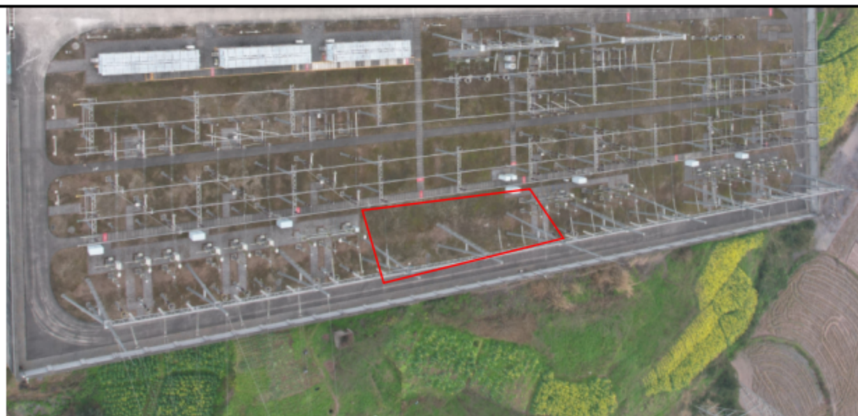
图2.3-2大石220kV变电站间隔扩建示意图
