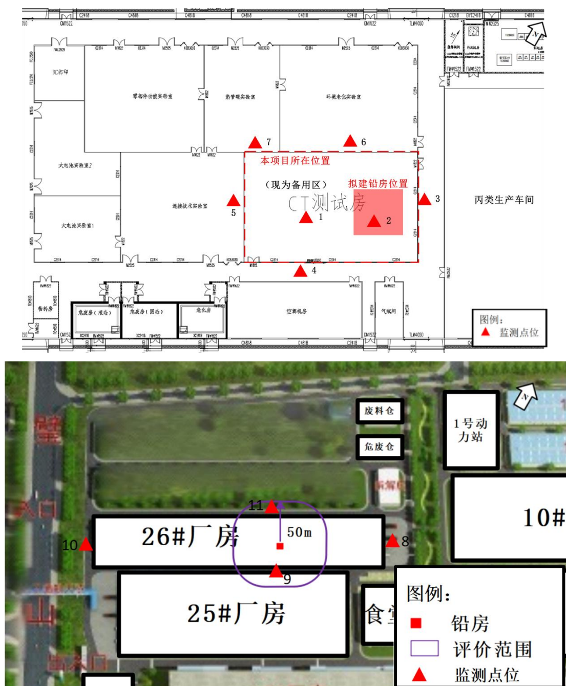
图 8-1 项目环境 \gamma 辐射剂量率监测布点示意图
