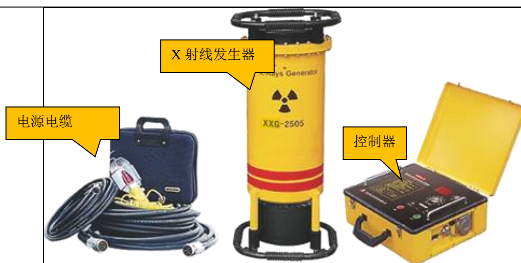
图 9-1 XXG-2505 型探伤机组组成图
