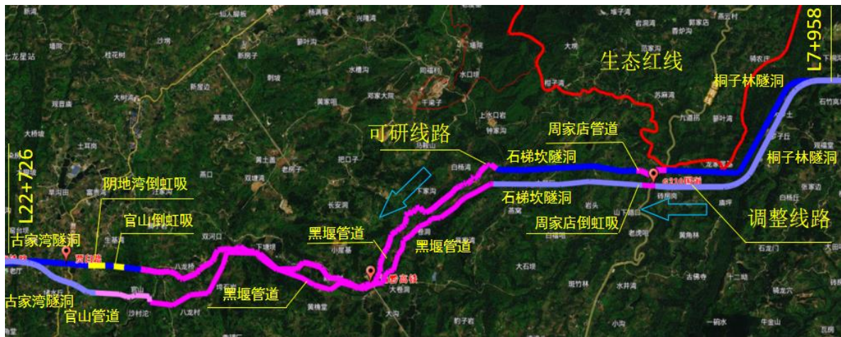
图 2.6-2 左干渠输水线路调整方案示意图
