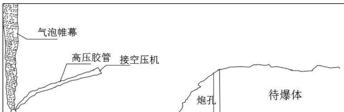
气泡帷幕装置示意图
