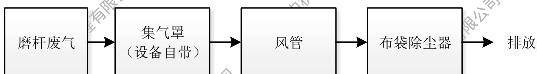
图 2.7-4 磨杆废气处理工艺流程
