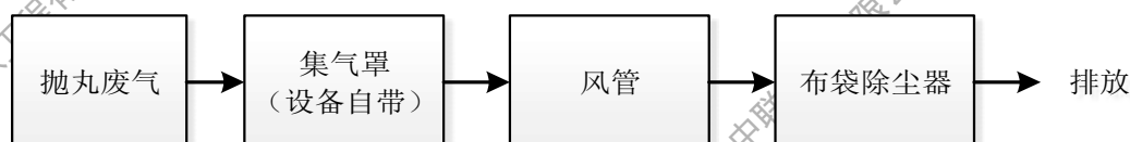
图 2.7-5 抛丸废气处理工艺流程
