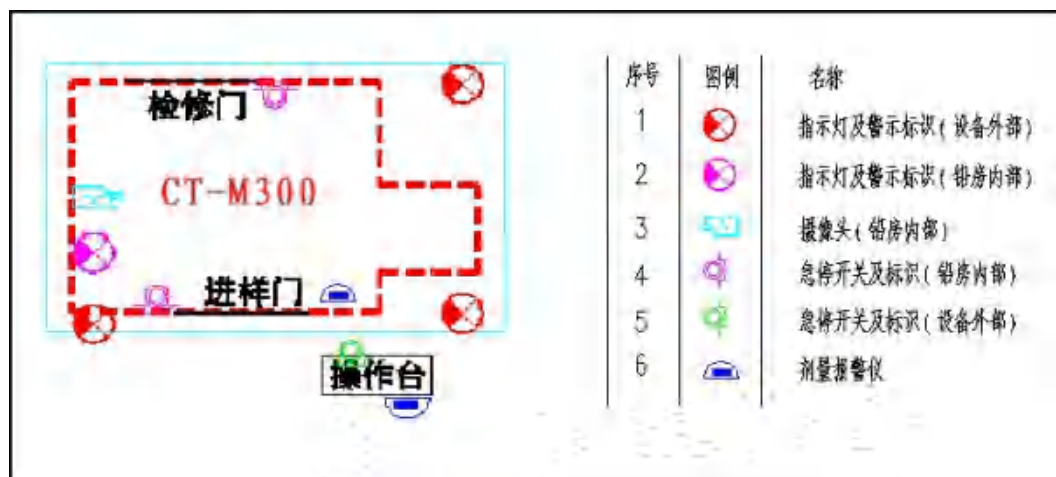
图 10-3 辐射防护安全措施图
