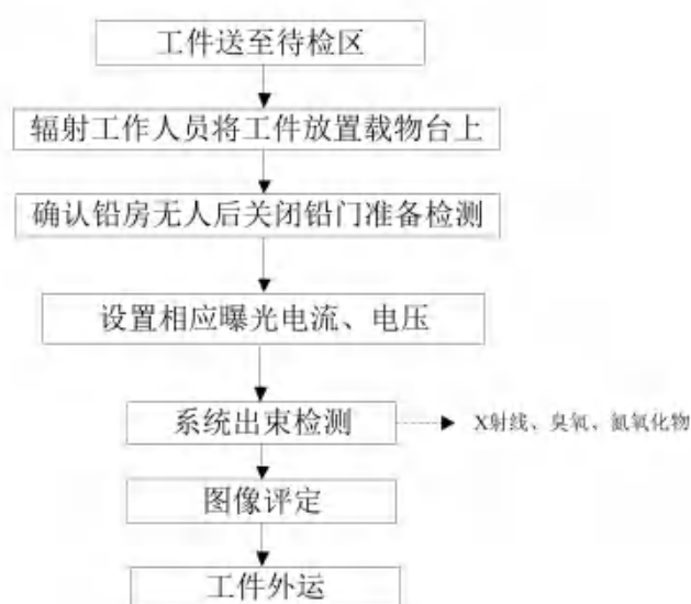
图 9-7 工业 CT 工艺流程及产排污简图
