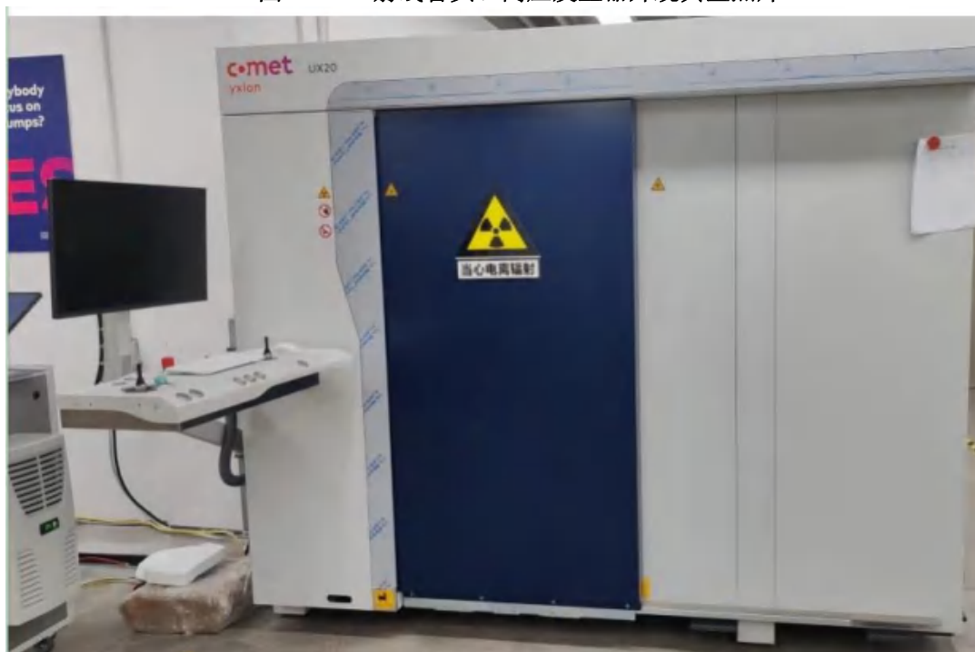
图 9-2 本项目 UX20 型工业 CT 外观典型照片
