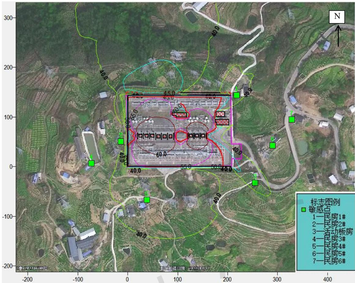
图 6-10 项目建成后噪声预测等声值线图
