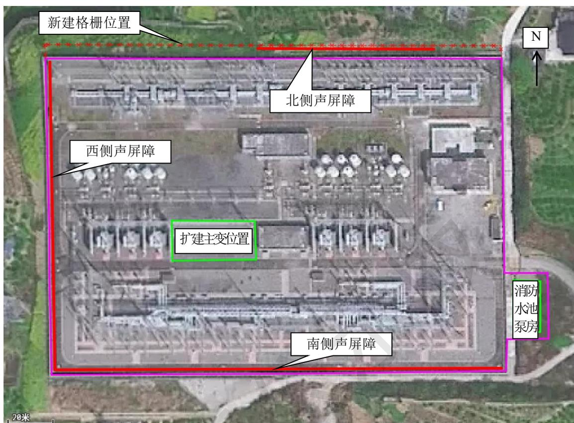
图 6-9 九盘 500kV 变电站噪声措施分布图
