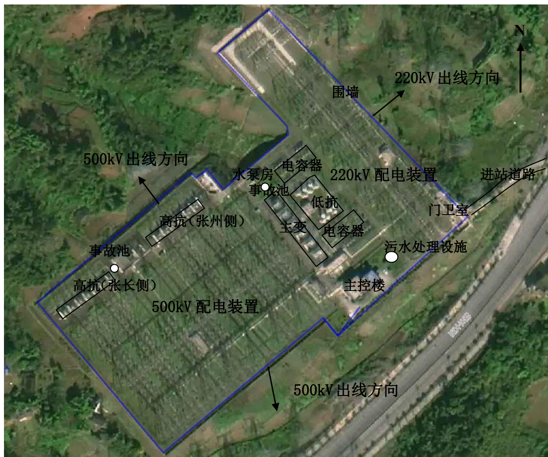
图 3-1 张家坝 500kV 变电站总体布局示意图
