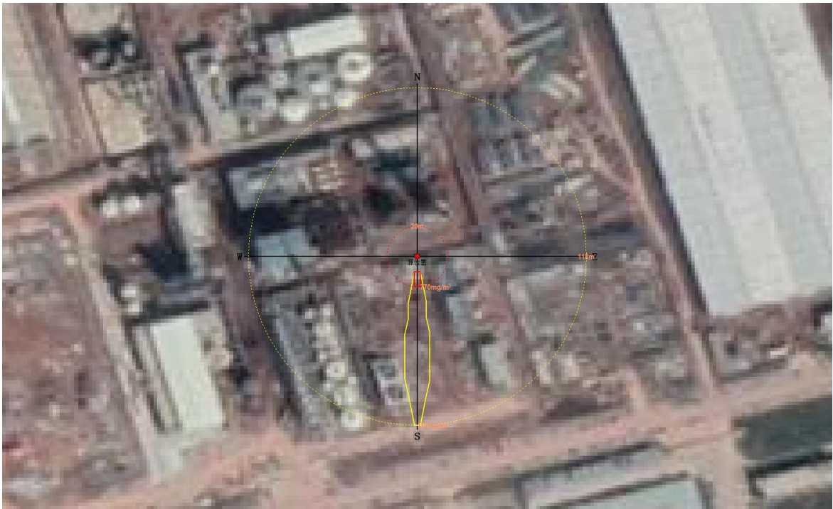
图 7.8.1-2 20%氨水储罐泄漏氨气扩散最大影响范围图（最不利气象）
