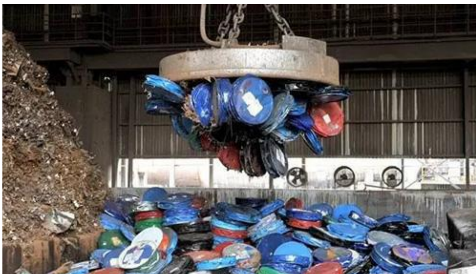
图 7.1-3 废铁质容器正在被吊运入废钢料斗
