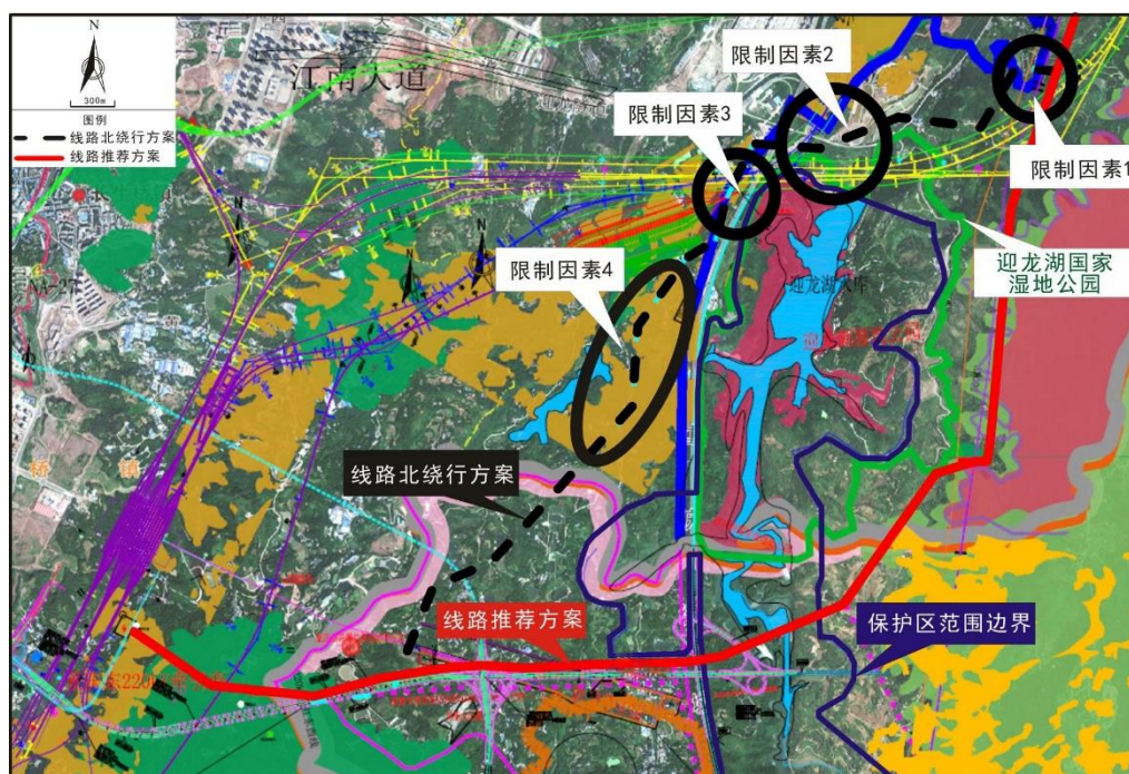
图 4-3 220kV 书东牵线绕行迎龙湖水库饮用水水源地北方案制约因素图
