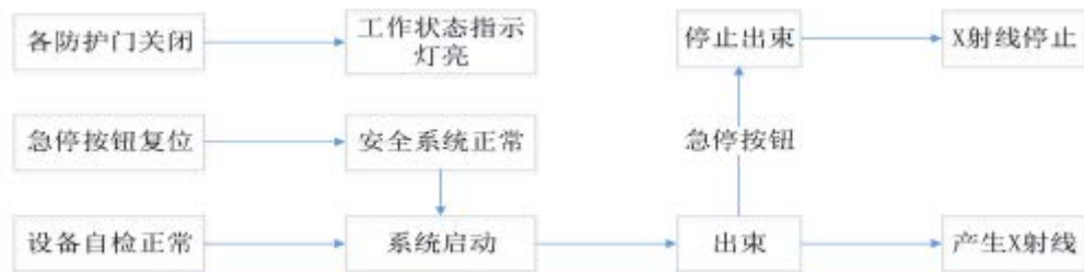
图10-3 本项目DSA辐射安全联锁逻辑图
