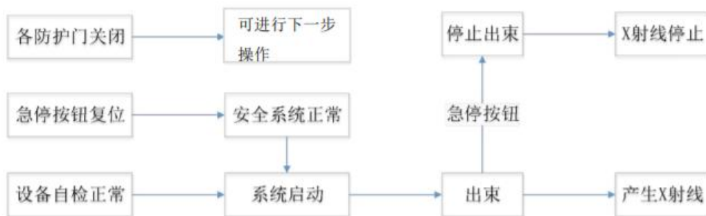
图10-2 辐射安全联锁逻辑图
