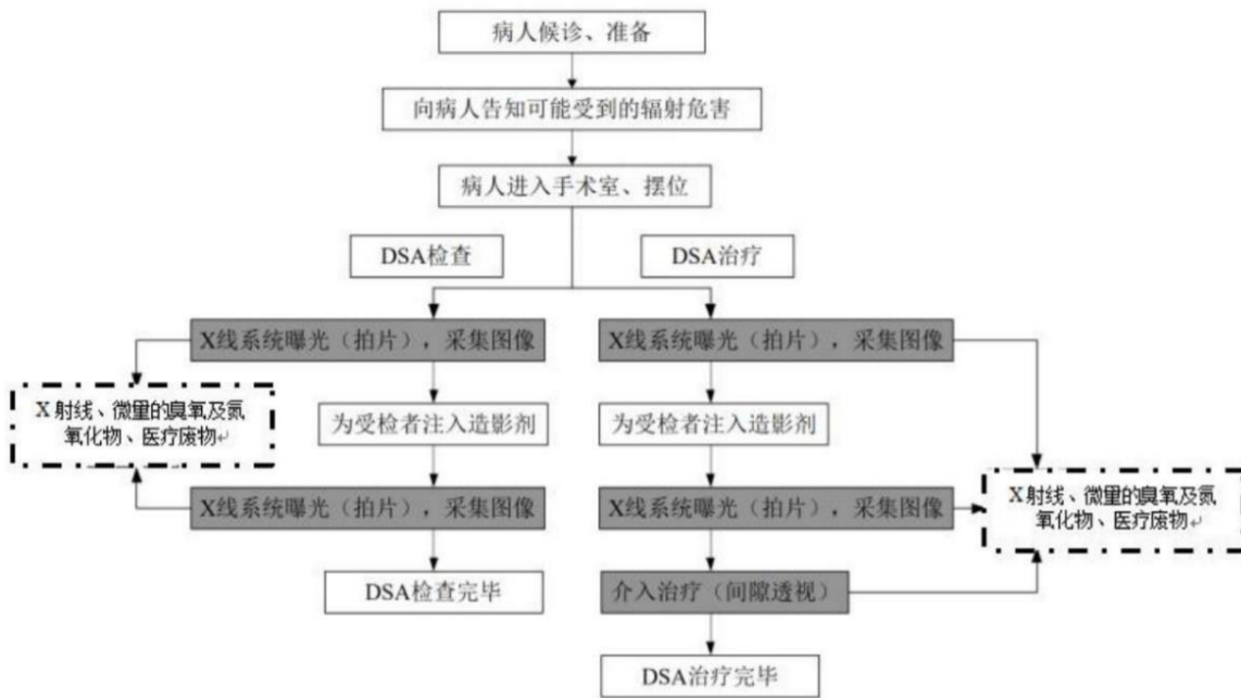
图 9.2.4 本项目 DSA 工作流程及产污环节示意图
