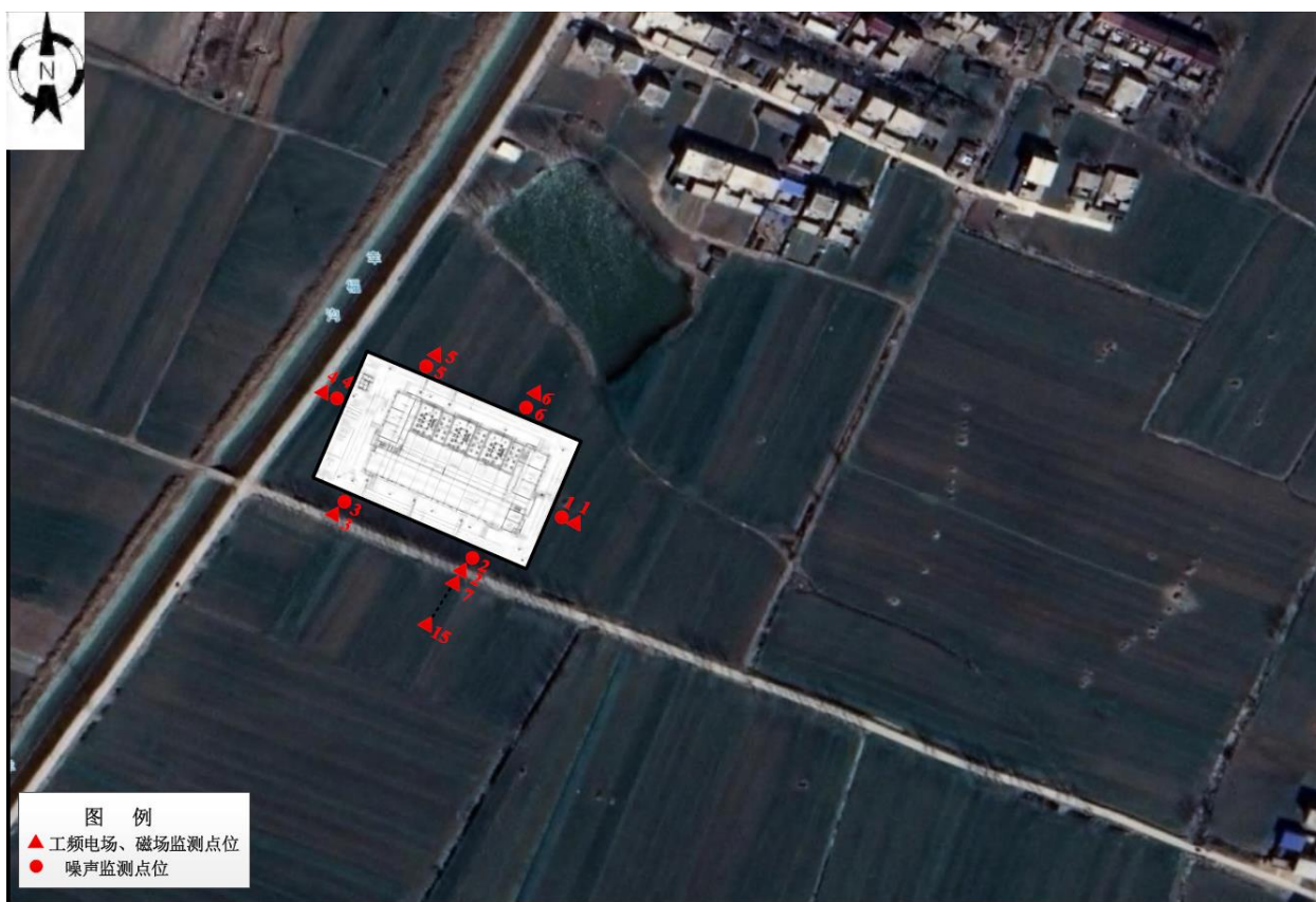
图 3.1-2 类比稻改 220kV 变电站监测布点示意图
