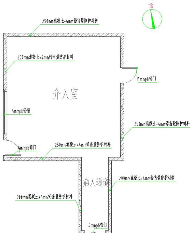
图 1-1 介入室屏蔽体防护平面示意图
