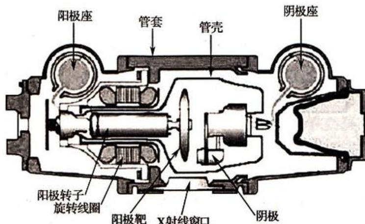
图 9-3 典型 X 射线管结构图
