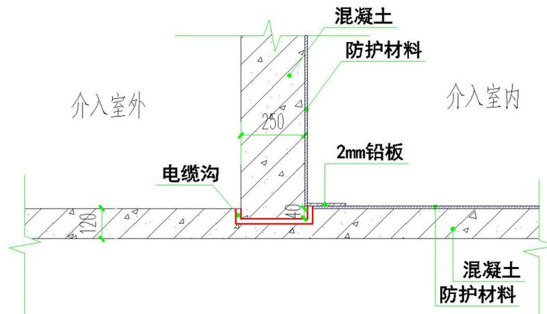
图10-3 项目电缆沟穿墙线管防护示意图
