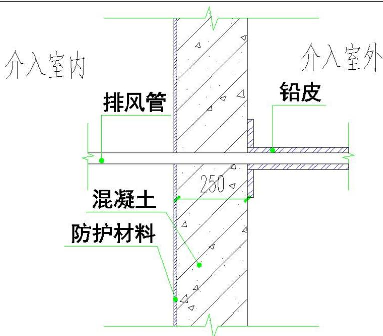
图10-4 项目排风管穿墙防护示意图
