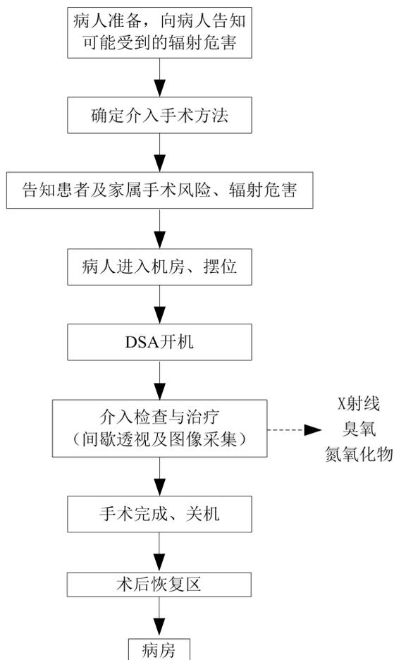
图 9-4 DSA 操作流程及产污环节图
