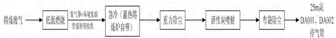
图 6.2-1 熔炼废气处理流程
