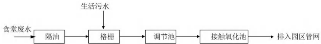
图 6.2-2 本项目生活污水处理工艺流程图
