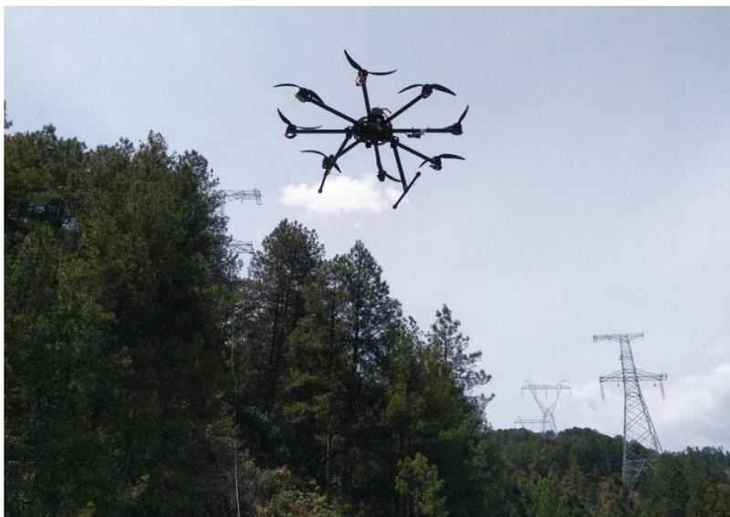
图 3.1-18 无人机放线施工示例
