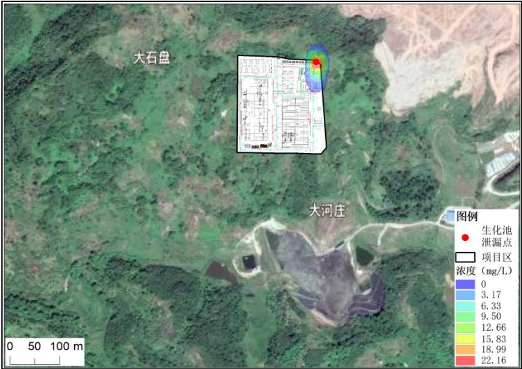
图 5.5-8 污染物氨氮污染晕运移分布图 第 100 天
