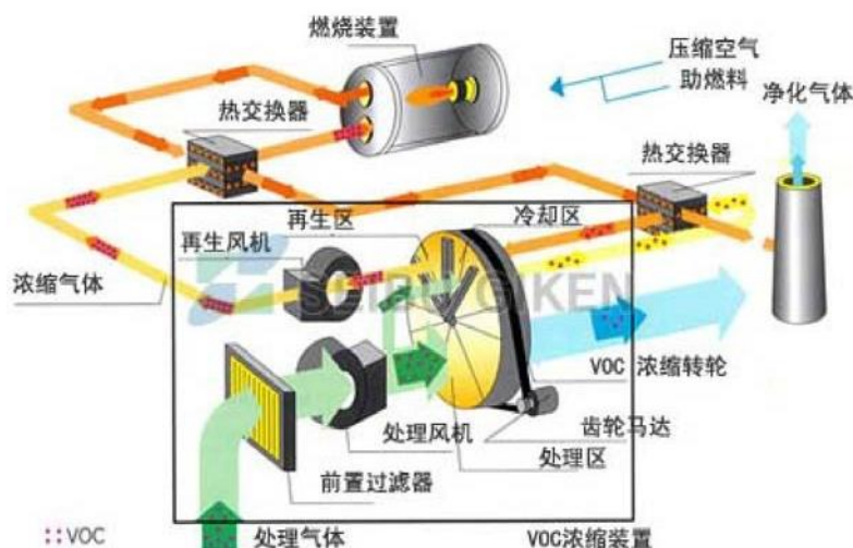
图 8.1.3 沸石转轮工作过程示意图
