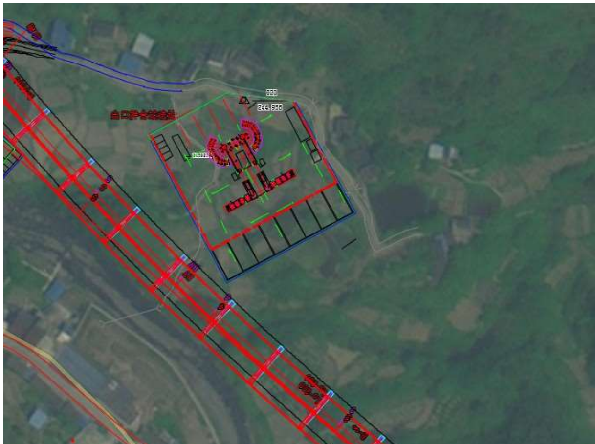
图 2-6-6 K27+500 处临时场地布置示意图
