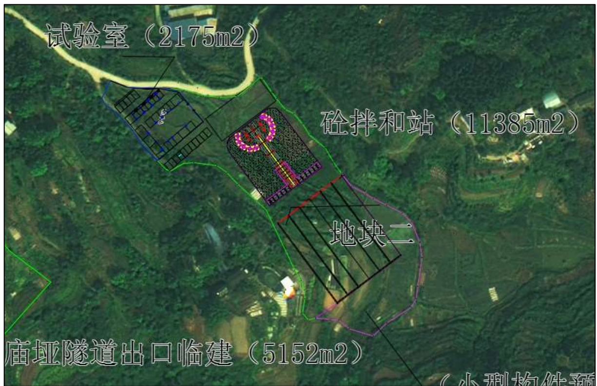
图 2-6-3 K12+400 处临时场地布置示意图
