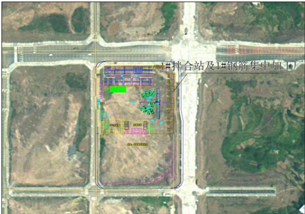
图 2-6-1 K0+117 处临时场地布置示意图
