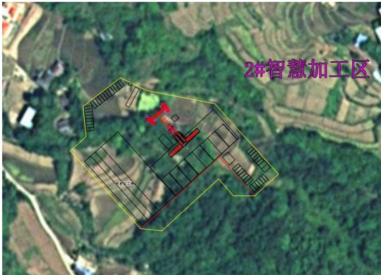
图 2-6-10 K43+200 处临时场地布置示意图
