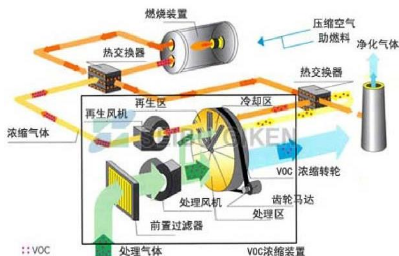
图 8.1.3 沸石转轮工作过程示意图
