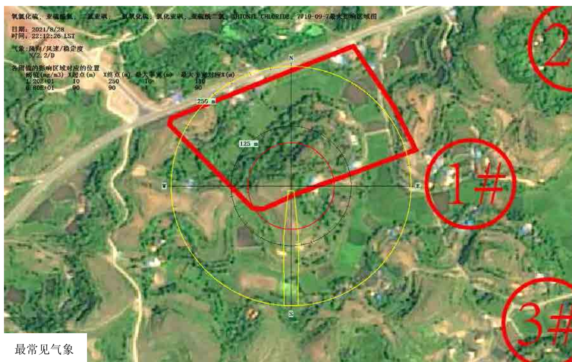
图 6.8.2 氯化亚砷储罐泄漏扩散最大影响区域图
