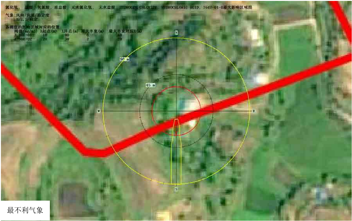
图 6.8.1 盐酸储罐泄漏扩散最大影响区域图
