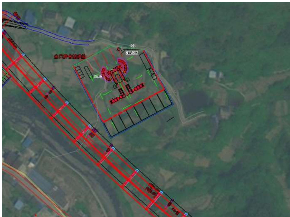
图 2-6-6 K27+500 处临时场地布置示意图
