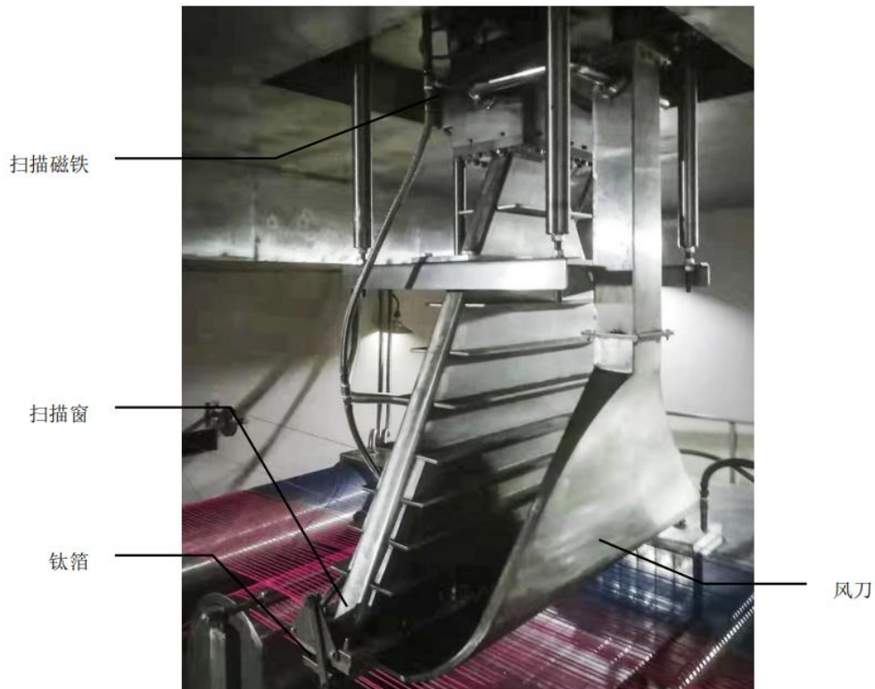
图9-5 束流引出系统示意图
