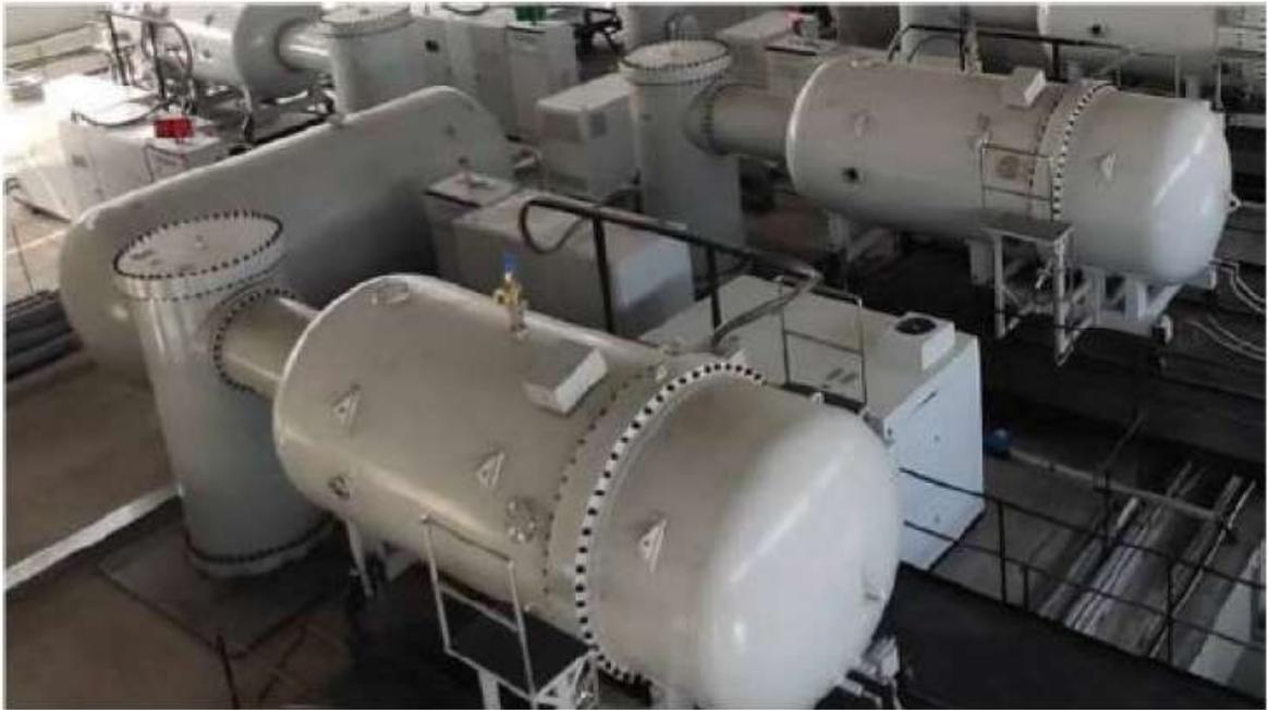
图 9-2 卧式工业电子加速器主机钢桶
