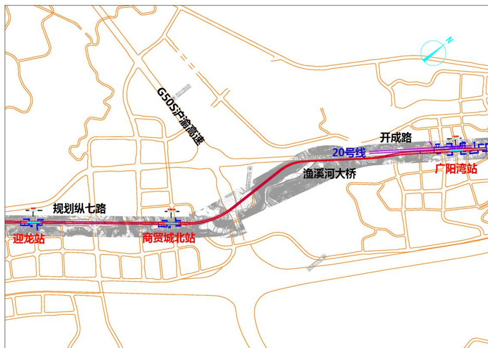
图 2.1-6 商贸城站~线路终点线路平面图
