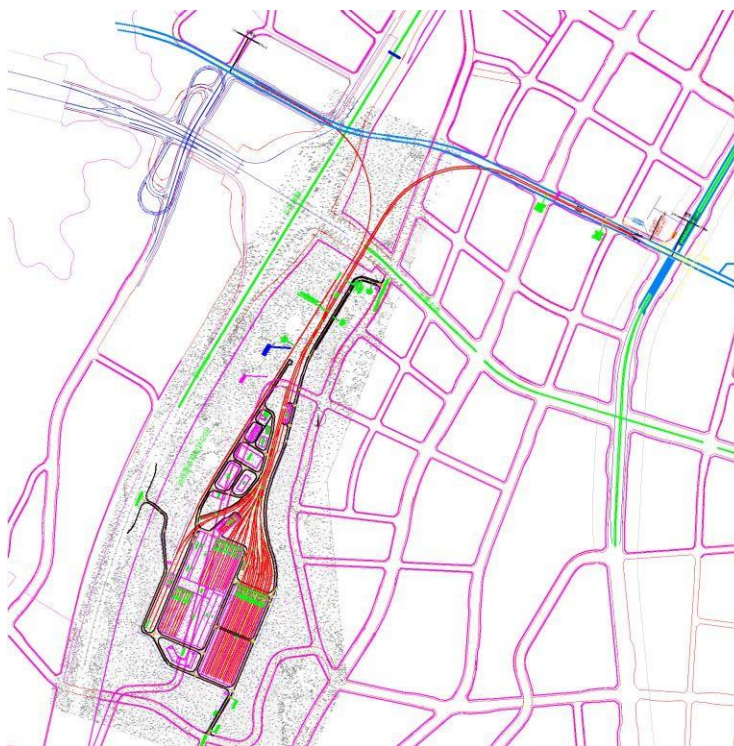
图 2.1-28 鹿角车辆段出入线接轨方案示意图
