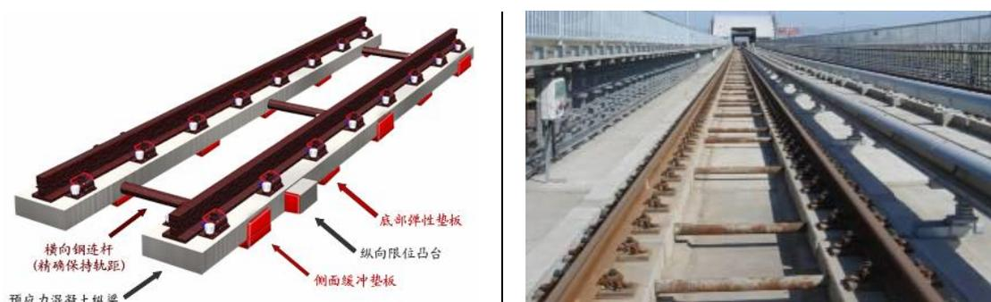
图 6.3-1 梯形轨枕(即纵梁式轨枕)的构成及实施照片
