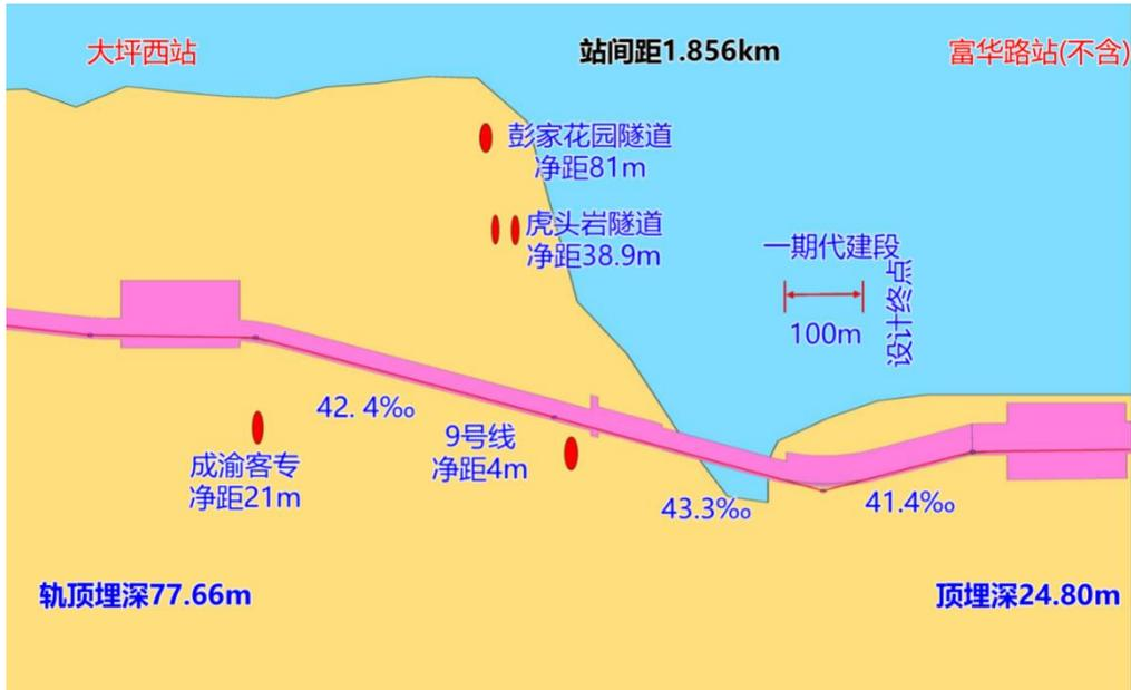
图 2.1-12 大坪西站-富华路站段纵断面示意图
