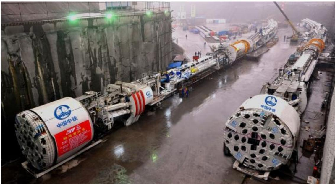
图 2.1-25 TBM 法施工设备
