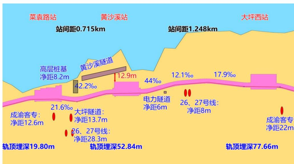
图 2.1-11 菜袁路站-大坪西站纵断面示意图
