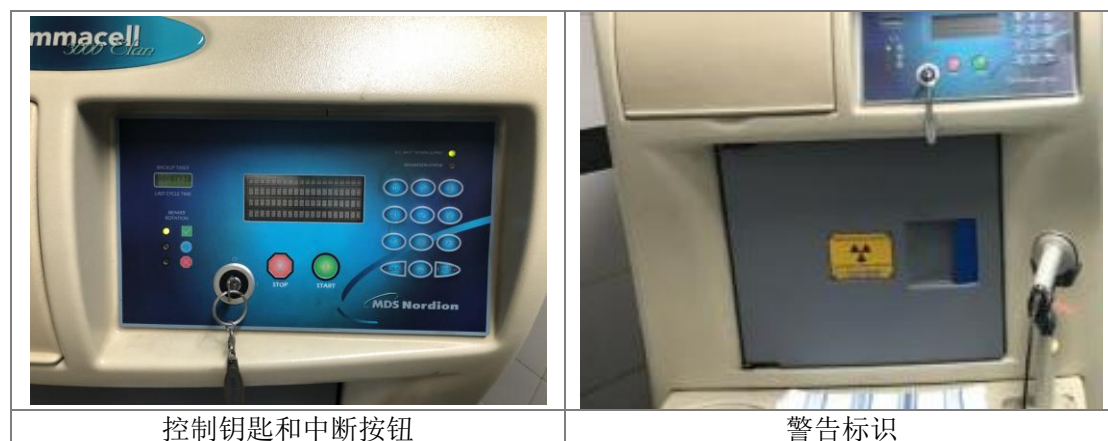
图 10-2 Gamma cell 3000 型血液辐照仪自带辐射防护措施相关照片
