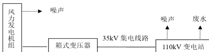
图 6.2-1 拟建项目运营期工艺流程图
