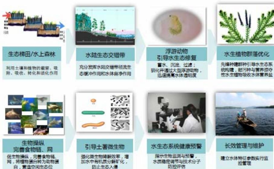
图6-17 八一水库水环境整治提升工艺流程图
