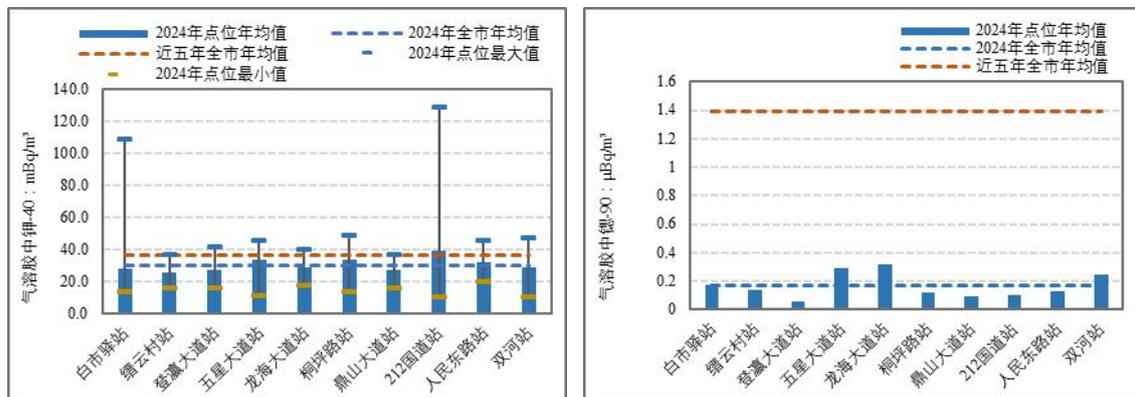
图 3-10 重庆市各自动站气溶胶中钾-40 和碘-90 监测结果
